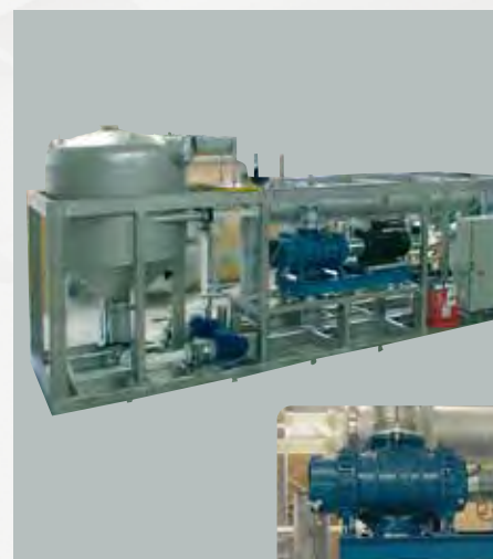
• ашиностроительная промышленность: обработка масляных эмульсий и моющих жидкостей с помощью концентрирующей установки термокомпрессии. оздуходувка вытеснения (RBS)
