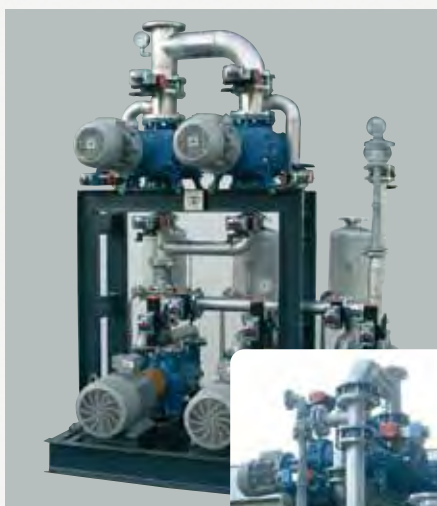
• ищевая промышленность: установки для процессов выпаривания - сушки оздуходувка высокого вакуума Soffiatore alto vuoto (RBS/AV) с использованием в качестве усилителя системы форвакуума
