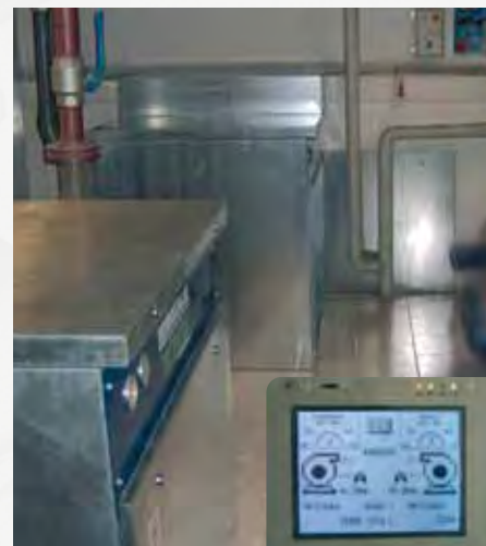
• Шартоная промышленность: централизованные вакуумные установки вытяжные агрегаты ROBOX evolution под давлением (P)/ вакуумные с инъекцией воздуха (DV)
