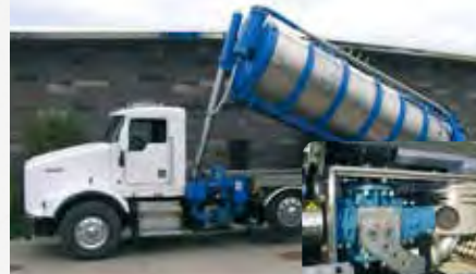
• передвижная установка для аспирации пыли и/или жидкостей вакуумный вытяжной агрегат: TRB-DV
